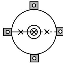
6. 本体上部を回転しても、測点が求心望遠鏡の二重丸の中央からずれていないことを確認する
