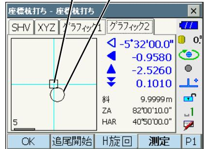
杭打ち点までの距離が 0m になる位置までターゲットを移動させて杭打ち点を探します。
