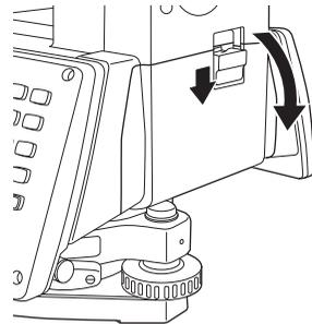
2. バッテリーの端子の向きを確認して、バッテリーを本体に押し付けて装着する
