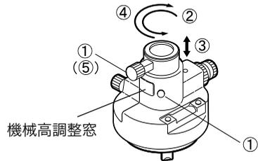
・機械高アダプターの気泡管は、以下の方法で点検・調整をしてください。
