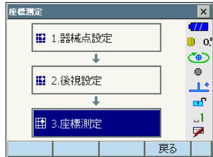
【測定】を押すと測定を開始します。【停止】を押して測定を終了します。目標点の座標値が表示されます。「グラフィック」タブを選択すると座標値がグラフィックで表示されます。
