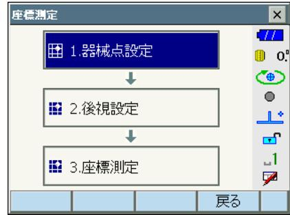
・【読込】を押すと、オプションプログラムの SDR8 サーベイにあらかじめ登録してある座標データを呼び出して器械点座標として設定できます。
