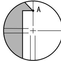
3. 望遠鏡微動つまみで静かに望遠鏡を動かして、目標点を縦線上の B 点へ移動させる
