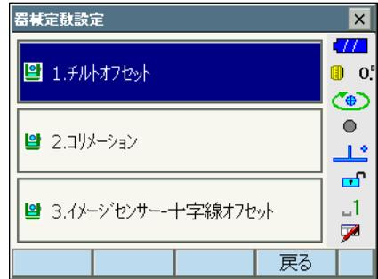
4. チルト X / Y 傾斜角が ± 1' 以内に入るように整準後、表示が安定するまで数秒待ち、現在の X 方向（視準方向）の傾斜角、Y 方向（横軸方向）の傾斜角を読み取る
