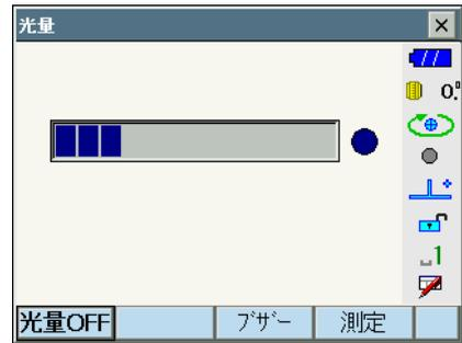
・【光量 ON】を押すと、受光光量がゲージで表わされます。
