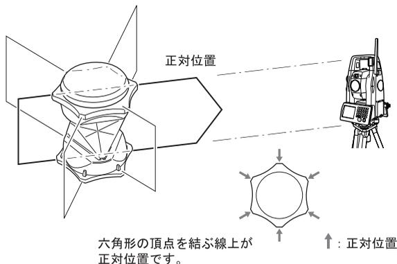
360° スライドプリズム (ATP1S) の場合は、プリズム上面の6本の印を直線に結ぶ線が、水平方向の正対位置です。
