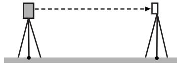
3. 観測モードで、望遠鏡「正」でターゲットの中心を視準して水平角 A1 と鉛直角 B1 を読み取る
