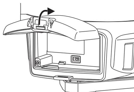
2. バッテリーの端子の向きを確認して、バッテリーを本体に押し付けて、右側にスライドさせて取り付ける
