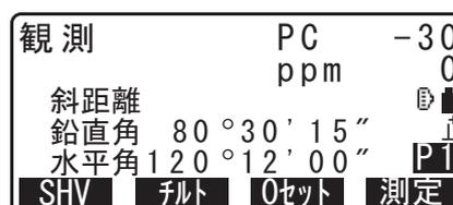
距離測定開始時に、EDM 情報（距離測定モード、プリズム定数補正值、ppm 値）が点滅表示されます。
