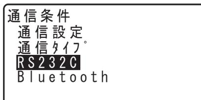
通信条件に合わせてRS232Cの通信条件を設定します。
