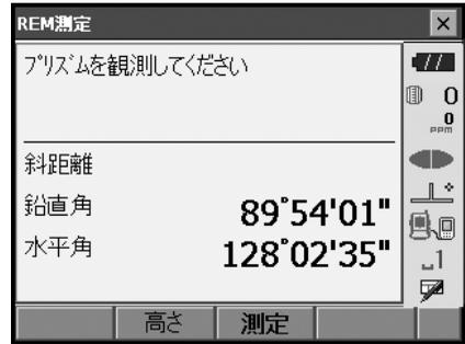
測定した距離・鉛直角・水平角が表示されます。
