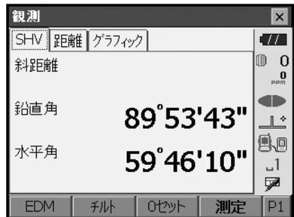
その後、測定した距離、鉛直角、水平角が表示されます。
