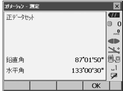
6. 目標物を望遠鏡「反」で正確に視準する
